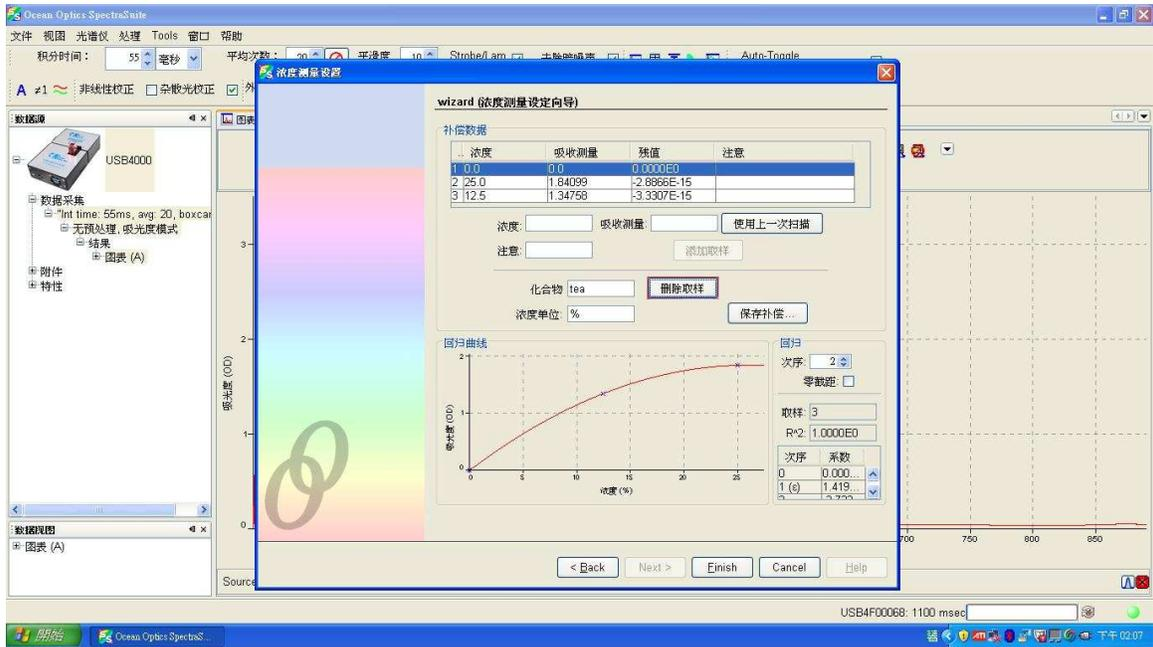
此介面跳出後，可以放入未知濃度樣品作量測，即可以馬上知道未知濃度的濃度。
