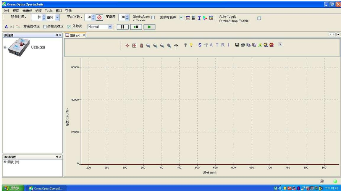
點選 **A** 將量測系統切換成吸光度測量
