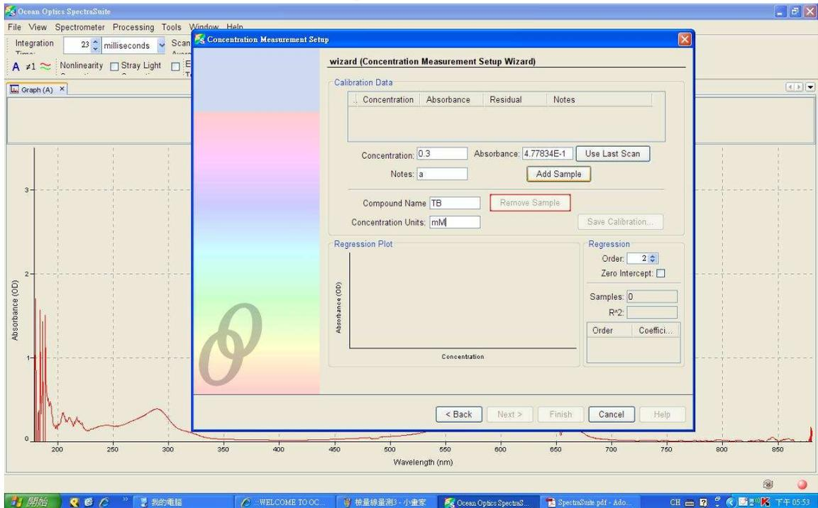
重複步驟將數個已知濃度樣品輸入資料，並且量測後紀錄，可以得到一檢量線，並且隨樣品不同選擇 Order 級數及是否通過原點。以上步驟選擇完畢，點選完成。
