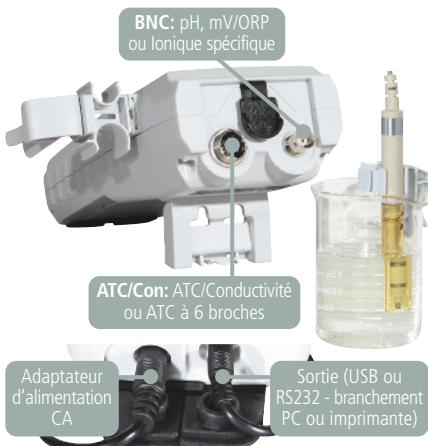
Les sondes de 12mm et 16mm peuvent utiliser le **support de fixation** pour fixer un ou plusieurs capteurs à un bêcher et à l'instrument, selon les besoins. Le support peut être étendu comme indiqué ci-dessus ou utilisé pour le montage mural.
